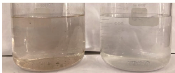
b 放置 168 h 后滴入 5 mL 1 mol/L 硫氰酸钾溶液的溶液状态
