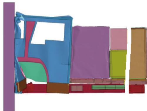
图 4 汽车高速撞击混凝土靶典型时刻变形与破坏形貌数值模拟结果
