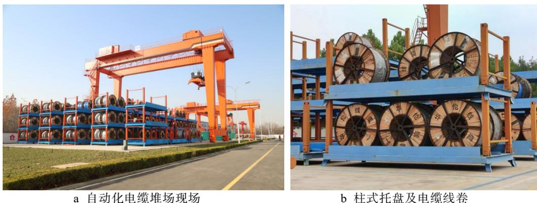
图 4 某地市电力物资仓库自动化电缆堆场
