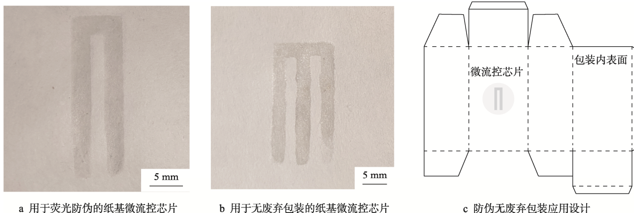
图 1 纸基微流控芯片及包装设计
