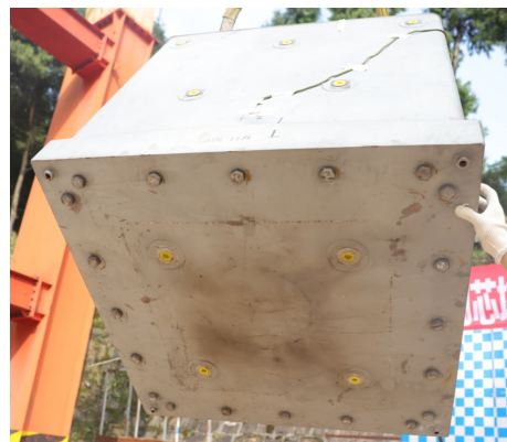
图 6 样机 9 m 跌落试验结果
