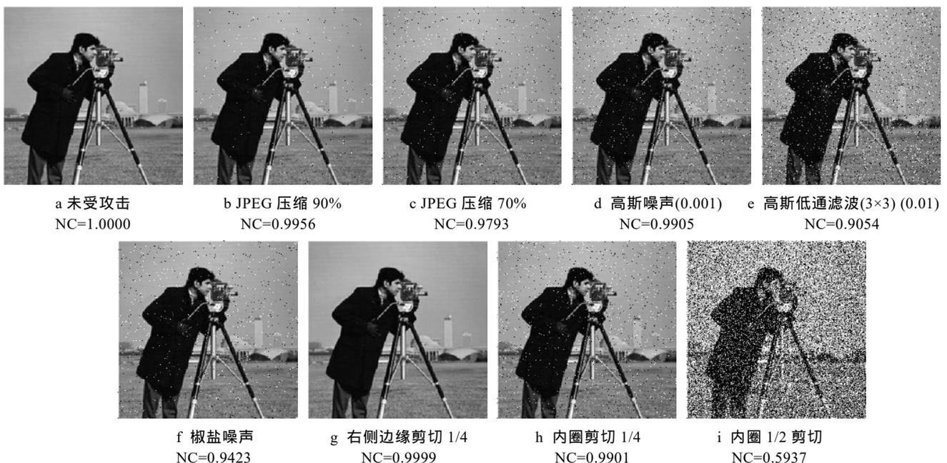
图 7 含水印图像受到攻击后提取的水印
