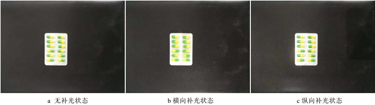
图 13 不同照射光线下的胶囊图片 Fig.13 Capsule pictures under different irradiation light
