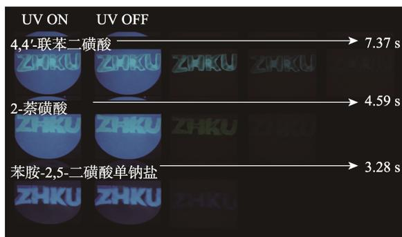
图4 3种芳香磺酸化合物制得油墨印刷后室温磷光效果及其磷光光谱
