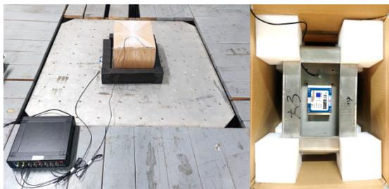
图 9 加速疲劳振动试验系统
