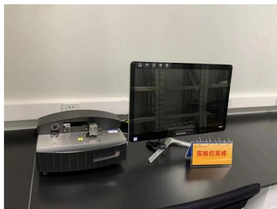
图7 HANATEK 折痕挺度测试仪
