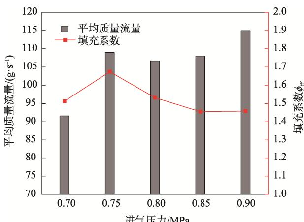
图 10 流量和填充系数随进气压力的变化趋势
