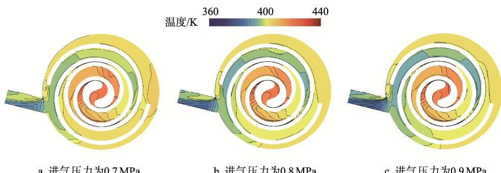
图 7 不同进气压力下温度场对比
