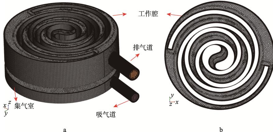
图 1 重叠网格离散后的计算域
