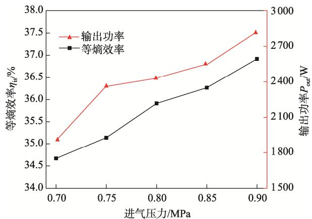
图 11 等熵效率和输出功率随进气压力的变化趋势
