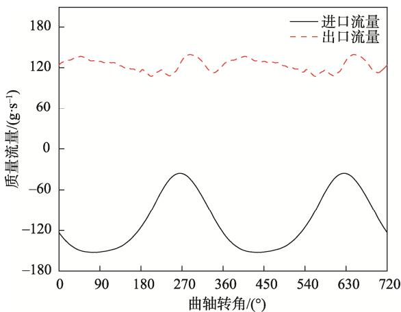
图 5 吸、排气流量随转角的变化
