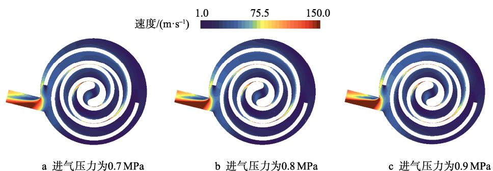
度场明显的变化差异。各进气压力下动涡盘的转速均为 5 000 r/min, 且压力梯度的上升对工质流速的增益作用有限, 因此总体上膨胀机工作腔内速度场分布随进气压力的变化不大。
