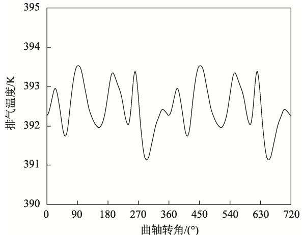
图 6 排气温度随转角的变化
