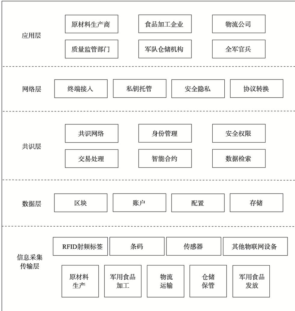
图6 系统架构
