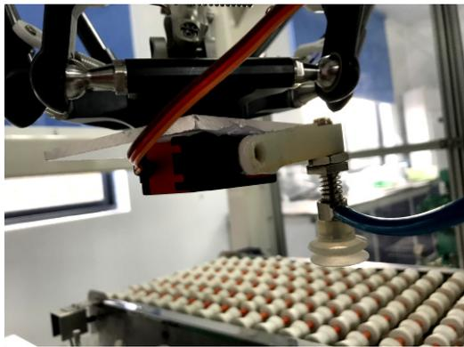
图 3 抓取吸盘的结构
