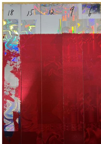
图 1 同一样品在不同储存时间下的油墨结合牢度实物图
