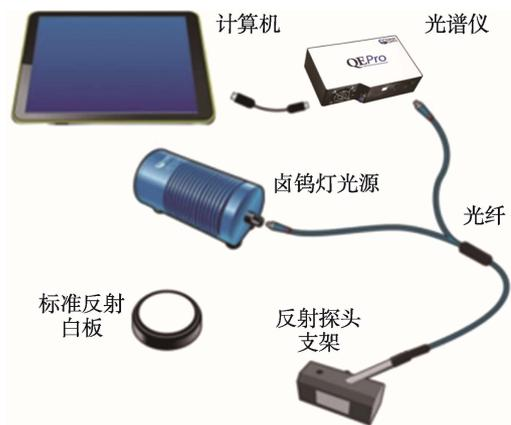
图 1 反射式光谱采集系统示意
