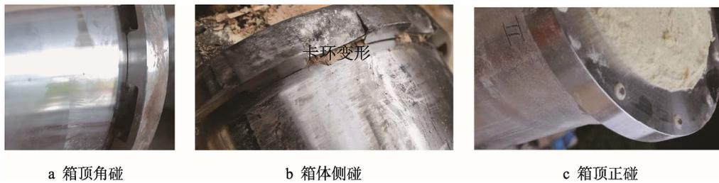
图 9 内容器密封结构变形
