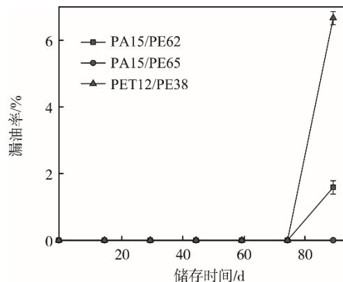
图1 不同材质灌装300 g 清油底料储存期间漏油率
