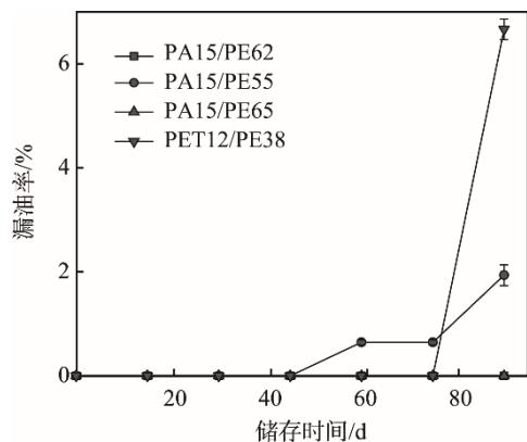
图 2 不同材质灌装 150 g 清油底料储存期间的漏油率
