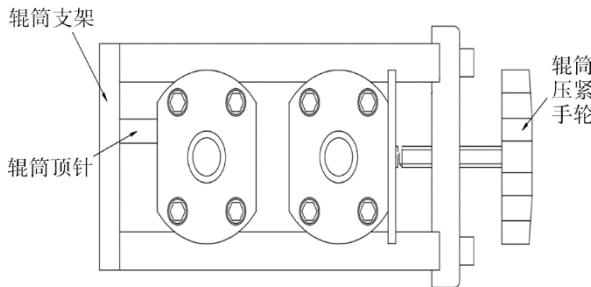
图4 自动制袋式填充包装机纵封调节示意
