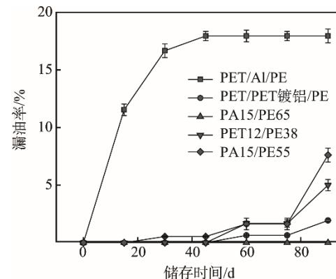
图 3 不同材质灌装 50 g 清油底料储存期间的漏油率
