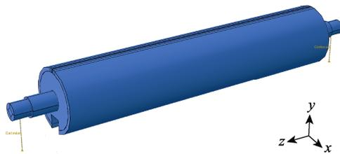
图 5 变刚度印刷滚筒有限元模型
