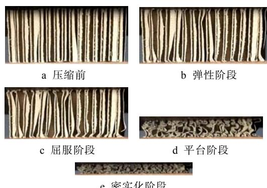
图3 0°试样侧压过程
