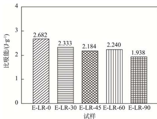
图 7 5 种角度试样侧压比吸能
