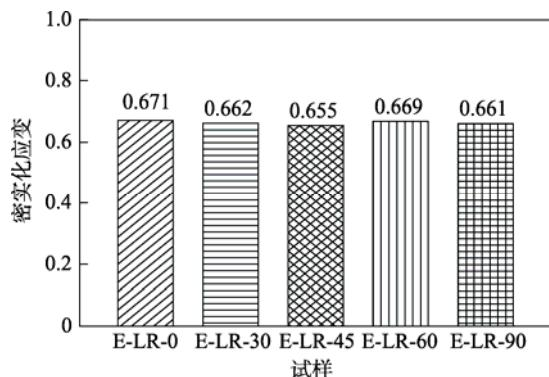
图 6 5 种角度试样侧压密实化应变
