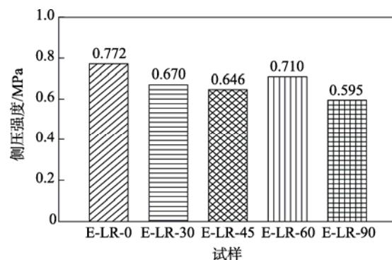
图5 5种角度试样侧压强度
