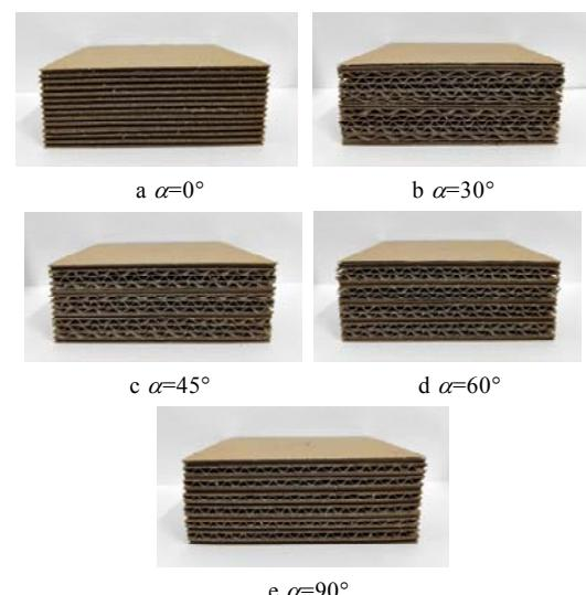
图2 逐层交错瓦楞纸板试样
