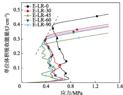
图 8 5 种角度试样侧压能量吸收曲线
