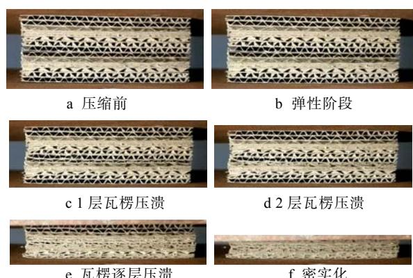
图 9  $30^\circ$  试样平压过程
