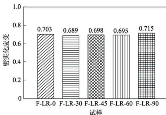
图11 5种角度试样平压密实化应变
