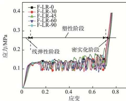
图10 5种角度试样平压应力-应变曲线
