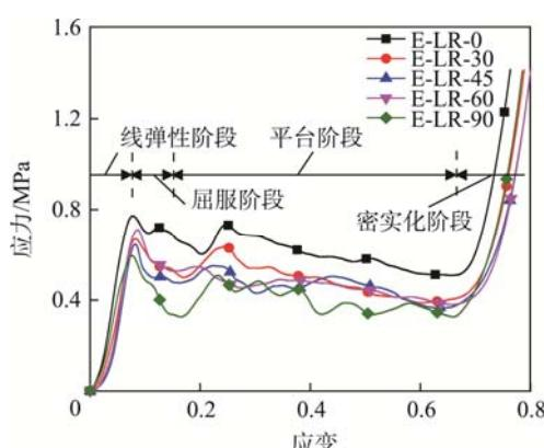
图4 5种角度试样侧压应力-应变曲线
