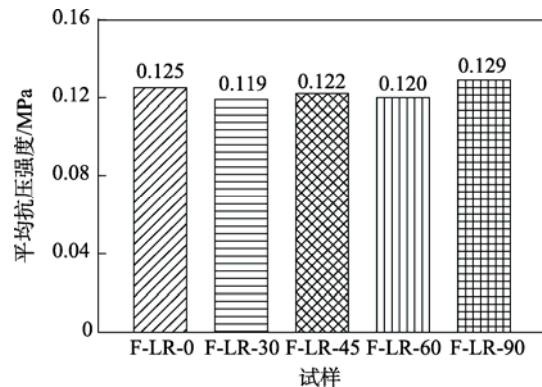
图12 5种角度试样平压平均抗压强度
