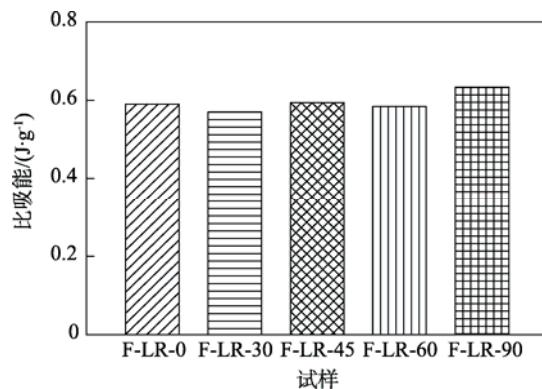
图13 5种角度试样平压比吸能
