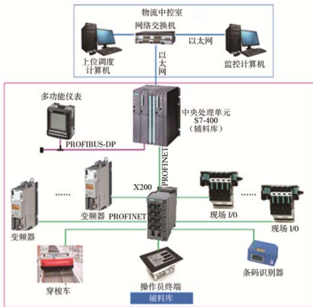
图4 辅料自动输送电控示意
