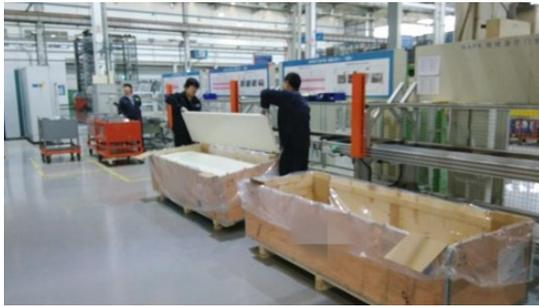
图 1 电梯厅门人工装箱方式
