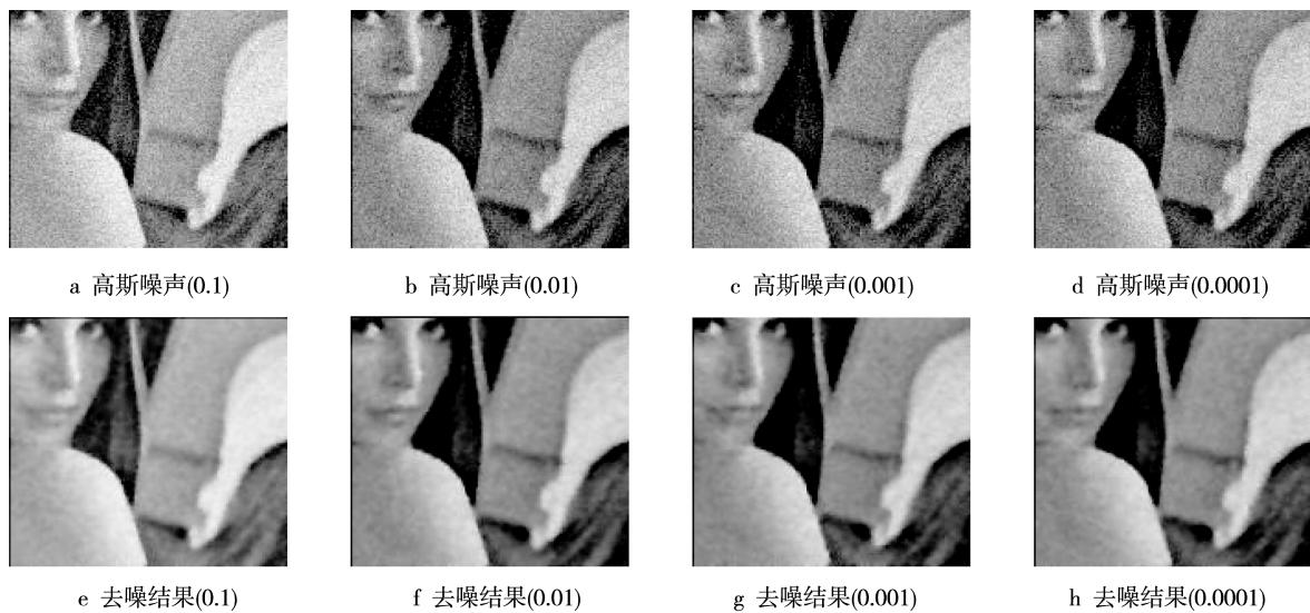
图 5 不同方差大小高斯噪声图像去噪结果(局部图)
