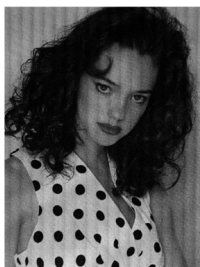
图2 带“排骨纹”的印刷品 Fig.2 Print with strips pattern
