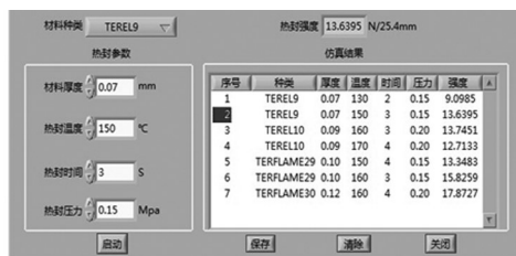
图5 LabVIEW热封强度计算界面
