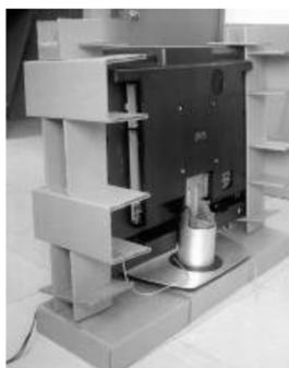
图 2 包装件跌落测试
