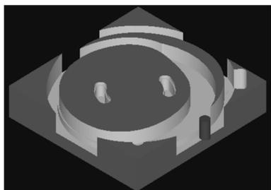
图 13 共轭凸轮的数控加工模拟
