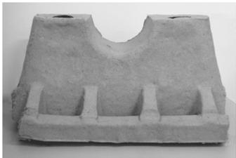
图4 纸浆模塑托盘连体支腿试样
