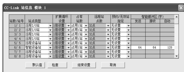
图3 无轴传动机组式印刷机控制系统通信初始化设置
